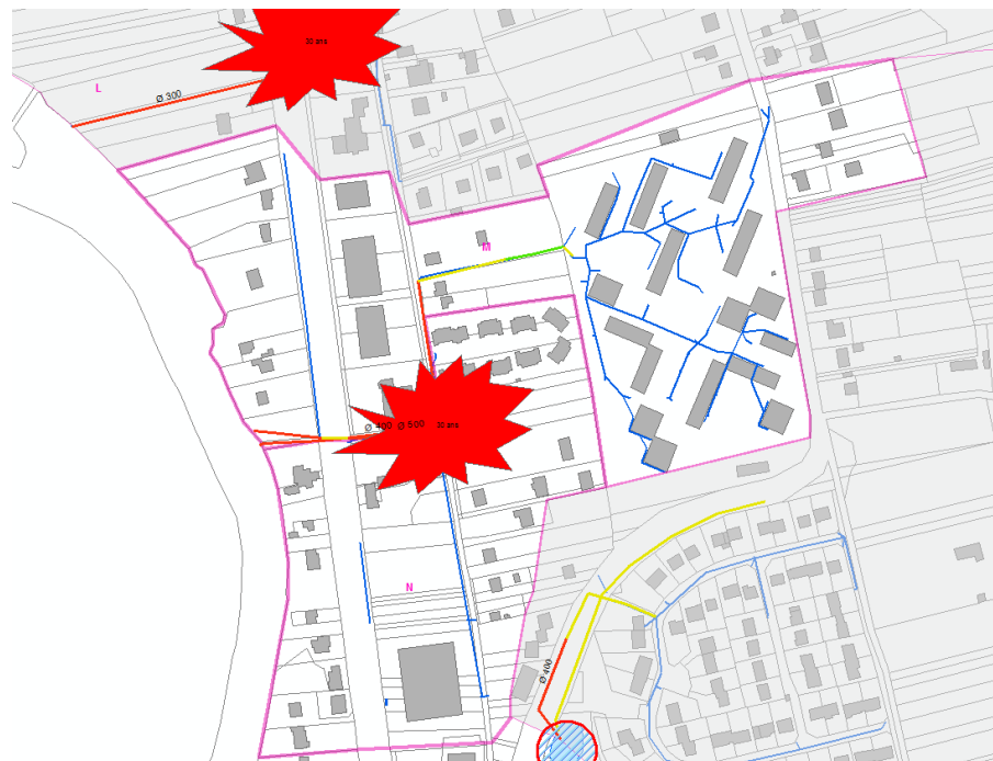
Fonctionnement hydraulique actuel (orage 30 ans)
