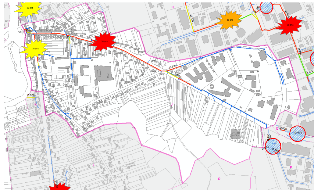
Fonctionnement hydraulique actuel (orage 30 ans)
