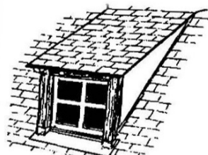
lucarne rampante ou en "chien couché"
