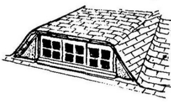
lucarne en trapèze (couv. bardeaux d'asphalte)
