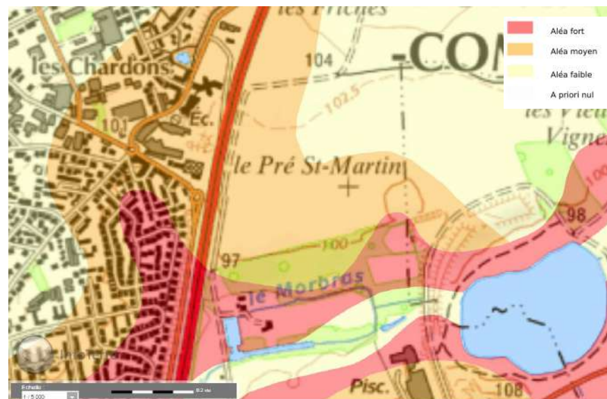
Figure 100 : Aléa retrait et gonflement des argiles – Secteur extension Sud de Pontillault
