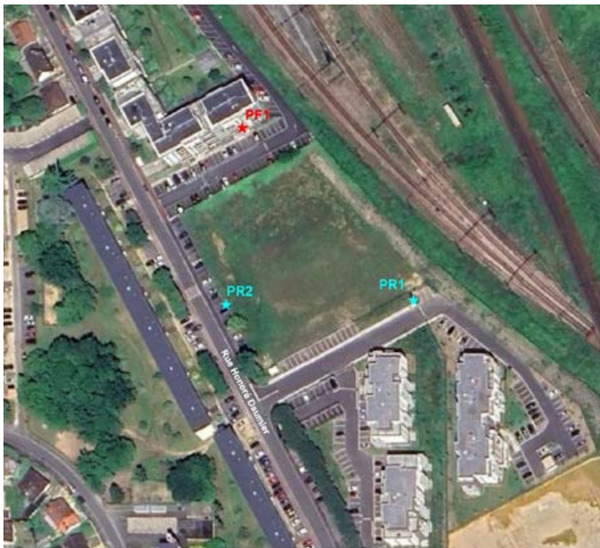
★ point fixe (PF) de 24h. ★ prélèvement (PR) de 1 heure Zones des positions et durées des mesures acoustiques.
