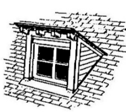
lucarne retroussée, ou demoiselle ; c'est aussi le vrai "chien assis"
