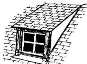
lucarne rampante ou en "chien couché"
