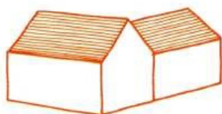
Bâtiment en équerre
