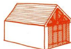
Pignon charpenté vitré
