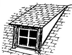
lucarne rampante ou en "chien couché"
