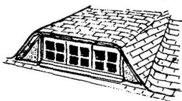
lucarne en trapèze (couv. bardeaux d'asphalte)
