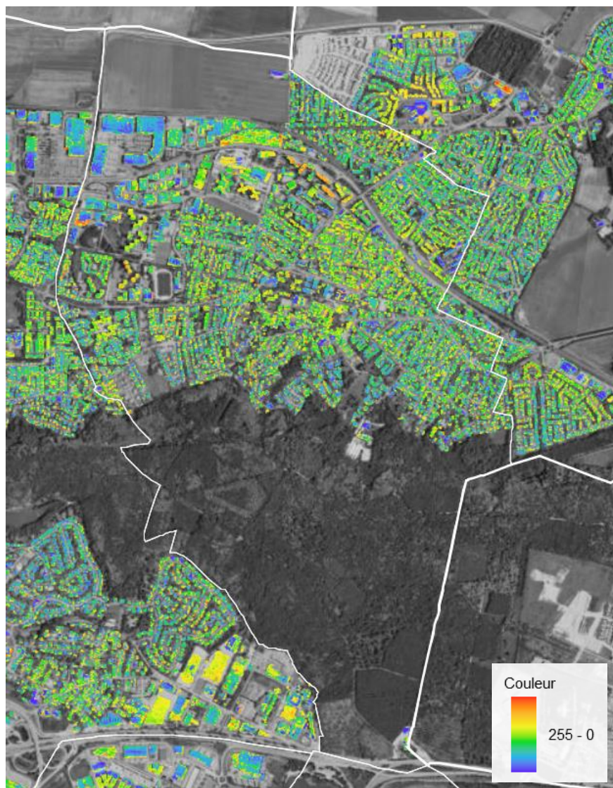
Figure 47 : Thermographie de la commune des Clayes-sous-Bois (source : SQY 2012)
