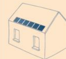
Composition en bandeau, en partie basse ou haute du toit
