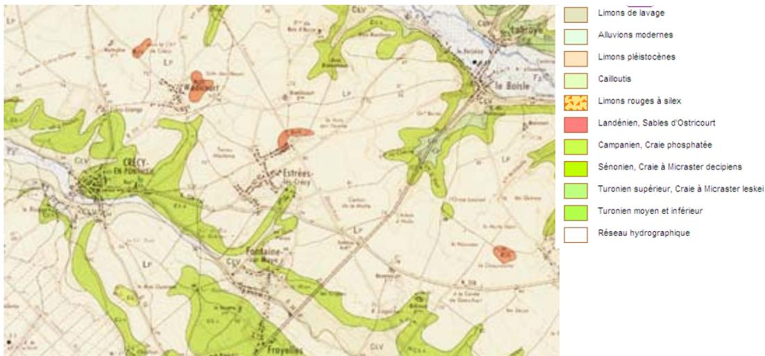
La géologie est similaire aux formations généralement retrouvées sur les affluents de la Somme : la craie blanche à silex affleure plus ou moins, recouverte sur les plateaux par des limons riches en sables et dans les vallées par des alluvions fluviales récentes, composées de graviers, sables, tourbes et limons.
