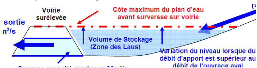
**Schéma de fonctionnement de la plaine des Laus - Source : Schéma pluvial, SOGREAH, mars 2010**
