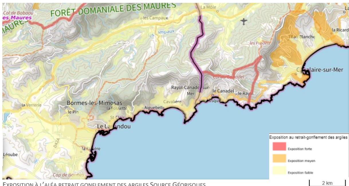
EXPOSITION À L'ALÉA RETRAIT-GONFLEMENT DES ARGILES SOURCE GÉORISQUES.
