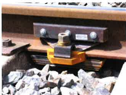
Figures 3 : Absorbeur sur rail & absorbeur sur platelage
