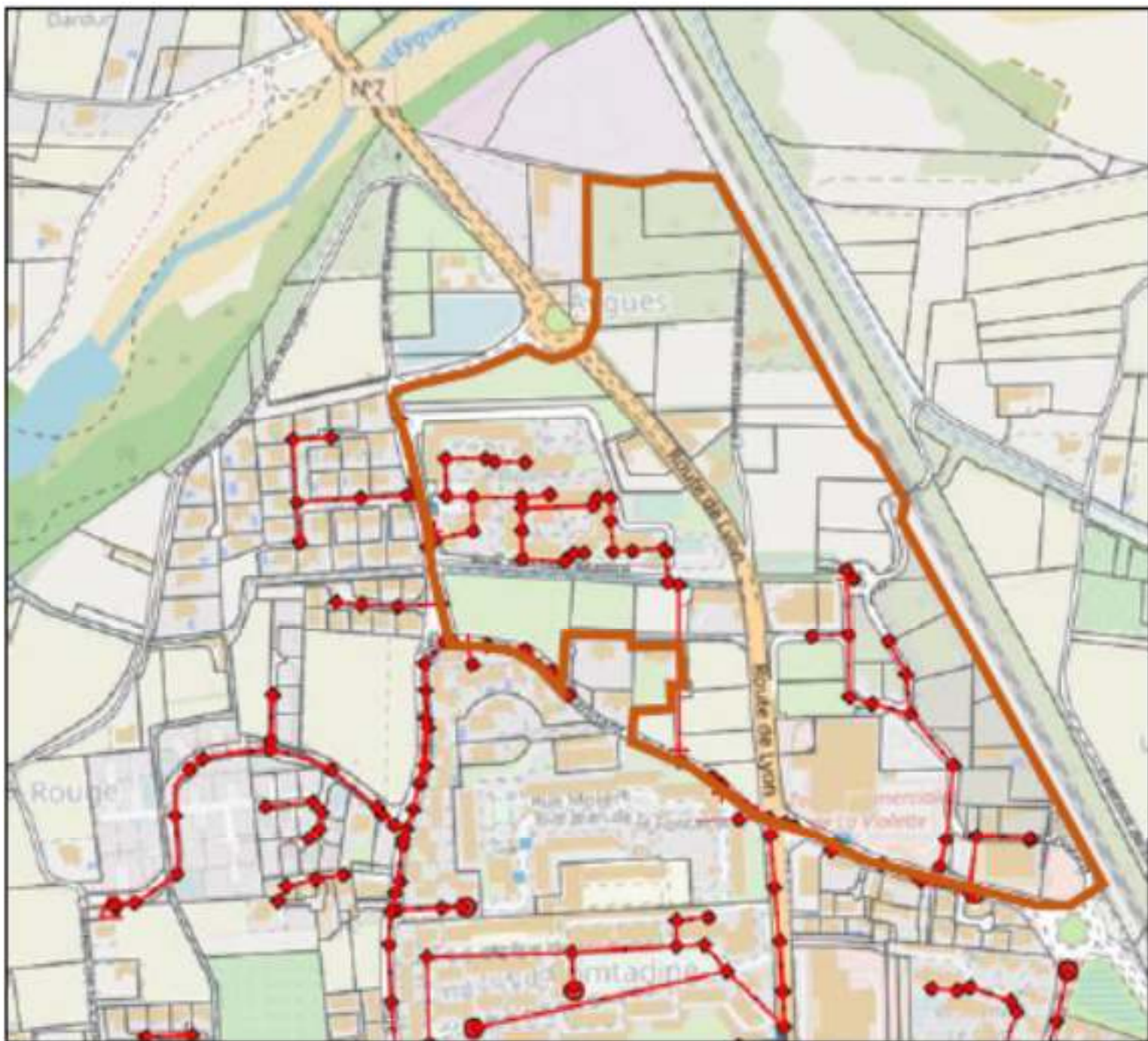
Réseau d'eaux usées
