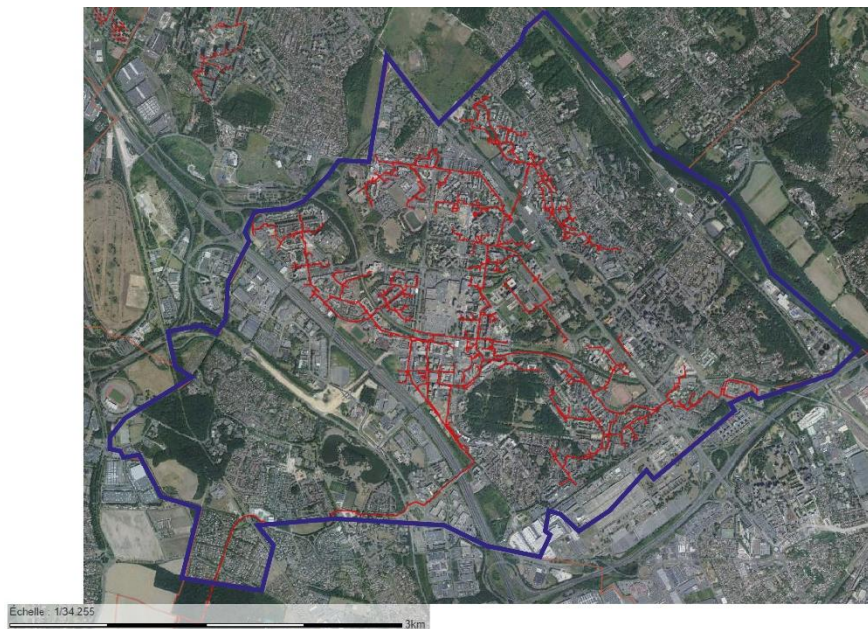
Réseau de chaleur à Évry-Courcouronnes en 2019 – Source : DRIAT Ile-de-France
