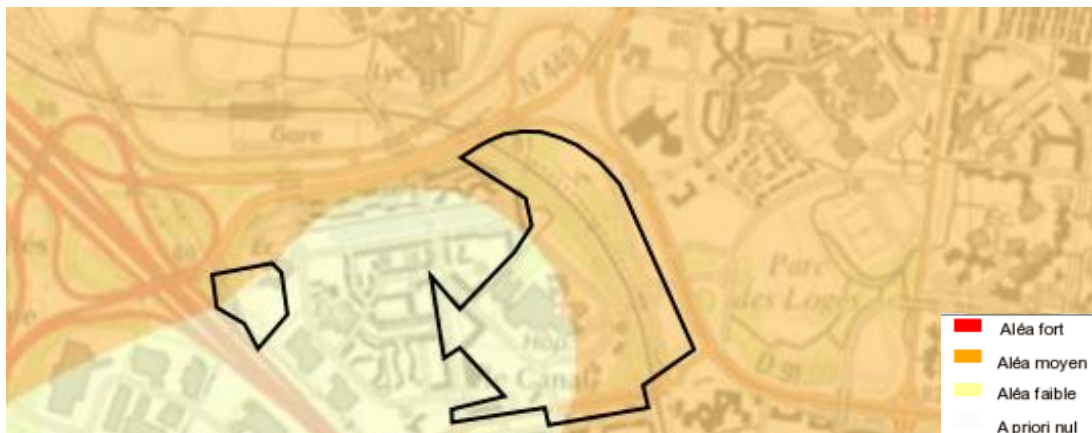
Détail du zonage de l'aléa « Retrait Gonflement des Argiles » - BRGM
