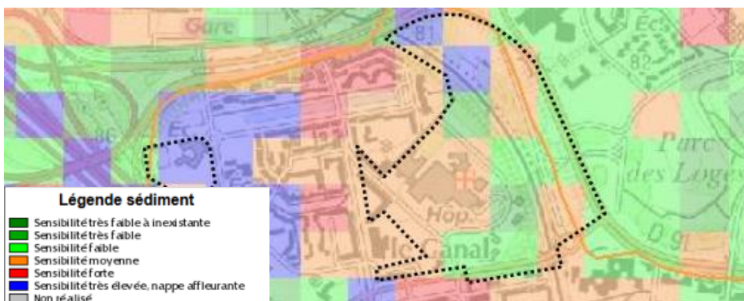
Zonage de l'aléa inondation par remontée de nappe. BRGM, 2018
