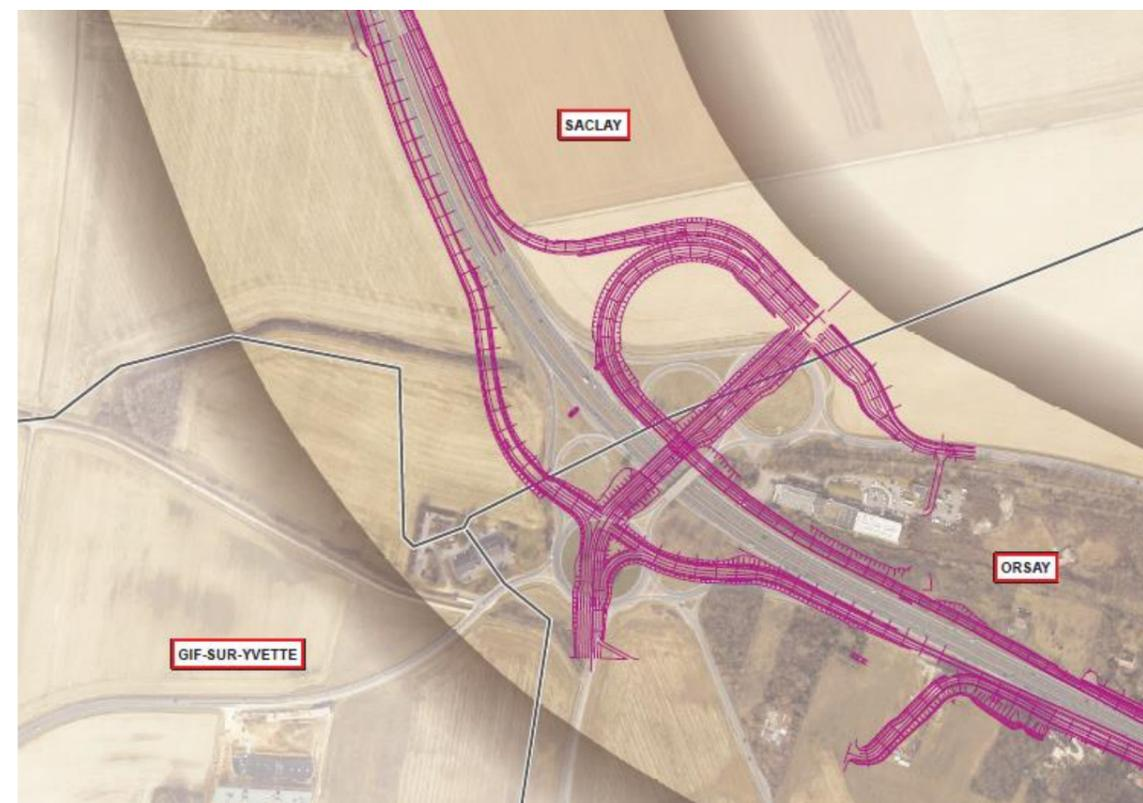
Le projet consiste à reconfigurer l'échangeur n°9 de Corbeville. Il prévoit de remplacer l'échangeur actuel constitué de giratoires par un échangeur asymétrique.
