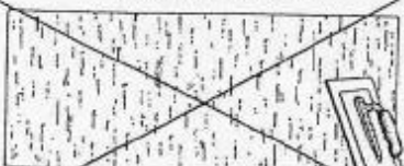
enduit ribbé verticalement (taloche "lisseuse" plastique)
