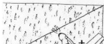
enduit rustique écrasé (par passage d'un couteau)
