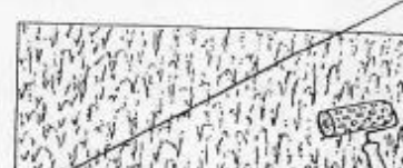
enduit trame au rouleau (diverses structures selon choix du rouleau)
