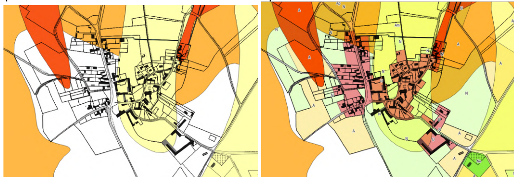
Carte de l'aléa retrait-gonflement des argiles, superposé avec le plan de découpage des zones. Source : BRGM
