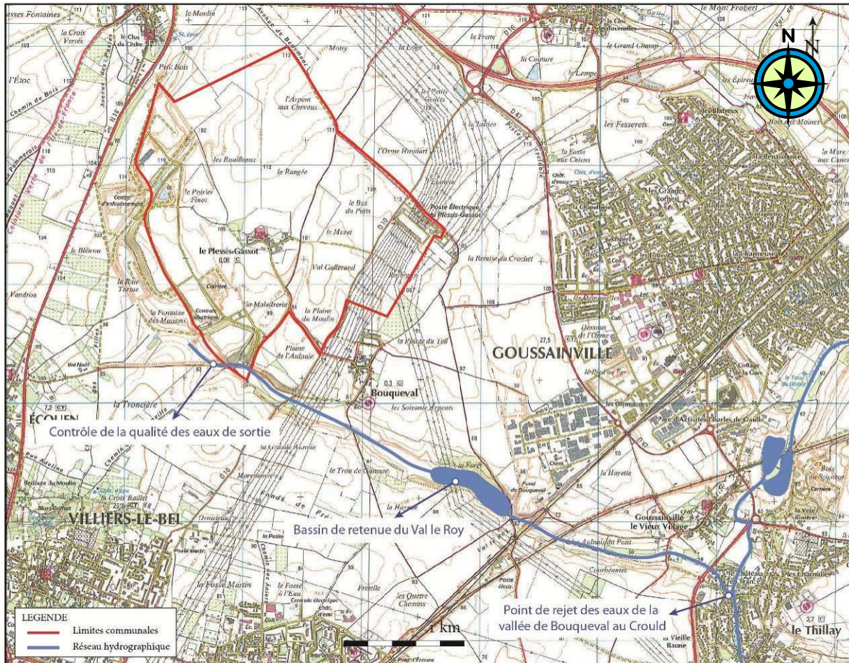
Figure 56 : Circuit hydraulique des eaux de rejet du centre de stockage et de la carrière
