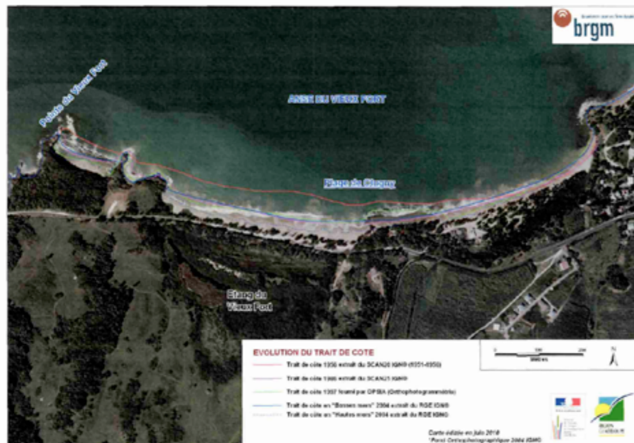
Un recul du trait de côte sur une épaisseur d'environ 50 mètres au niveau de la plage de Cluny
