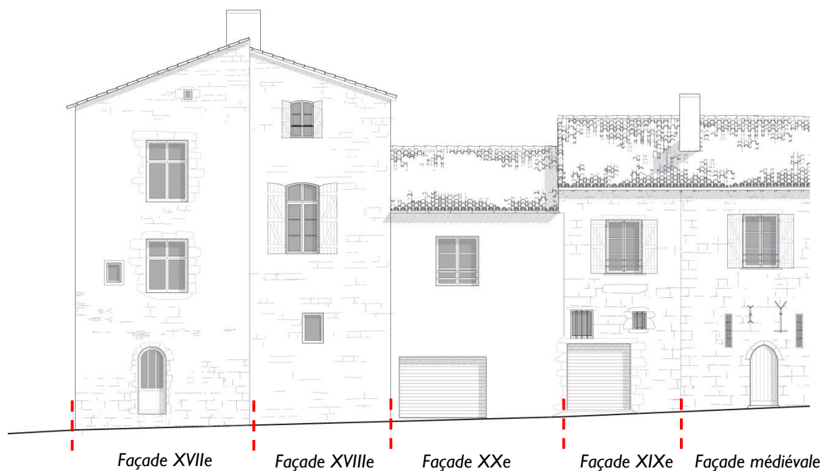
Composition superposée de façades d'ilot ayant toute une origine médiévale
