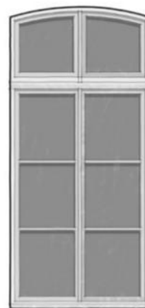
Fenêtres XIXe et XXe siècle : le verre s'affine et la fenêtre s'agrandit, l'étanchéité se perfectionne. Généralisation de la crémone comme système de fermeture.
