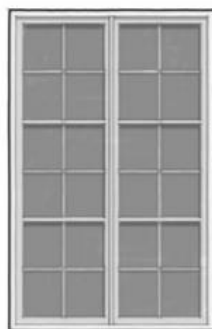
Fenêtre XVIIIe siècle : le développement du verre et le souci de mieux éclairer inaugurent la réalisation de hautes baies avec petits bois. Apparition de l'espagnolette.
