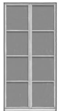
Fenêtres XIXe et XXe siècle : le verre s'affine et la fenêtre s'agrandit, l'étanchéité se perfectionne. Généralisation de la crémonne comme système de fermeture.
