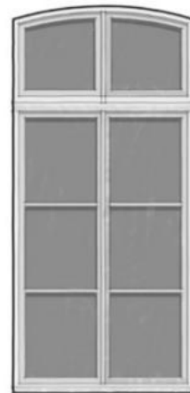
Fenêtres XIXe et XXe siècle : le verre s'affine et la fenêtre s'agrandit, l'étanchéité se perfectionne. Généralisation de la crémonne comme système de fermeture.
